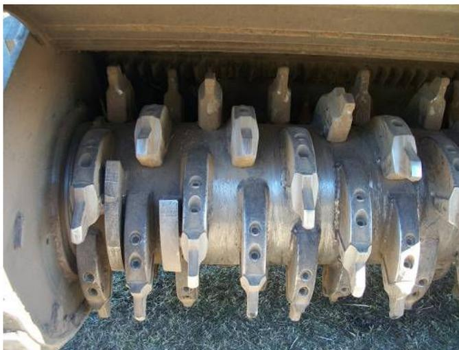
Figura 10. Detalle de elemento de picado de Trituradora de restos FAE 150 MH.
