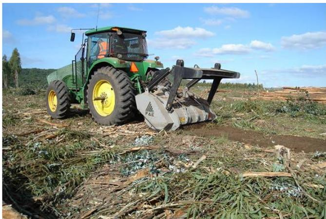
Figura 11. Trituradora de restos FAE 150 MH operando sobre los restos de cosecha.
