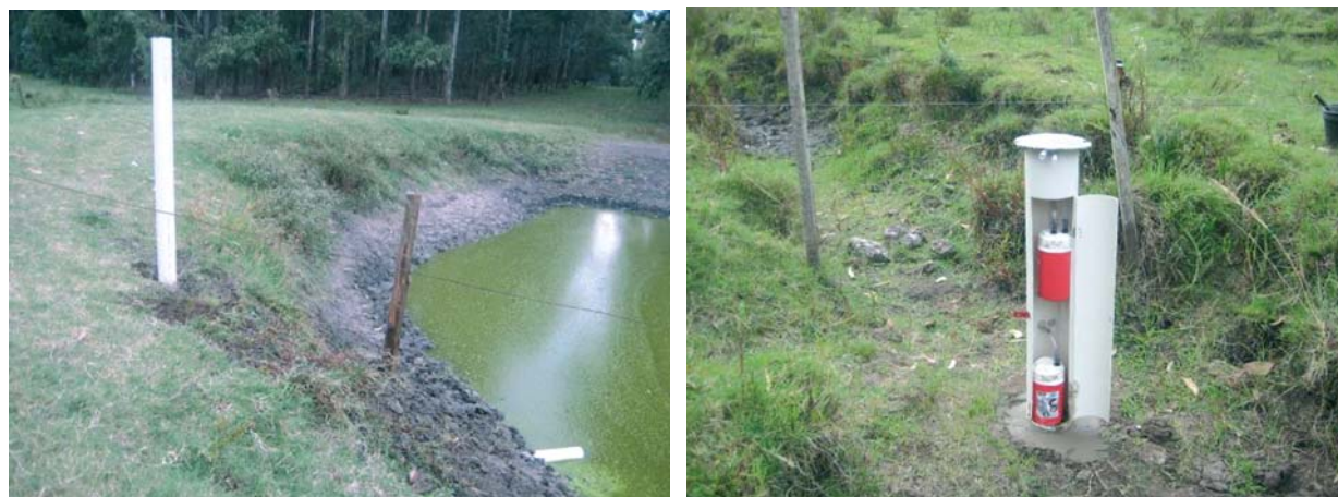
Limnógrafo Santo Tomás 1 localizado en un tajamar existente al cierre de la cuenca.
